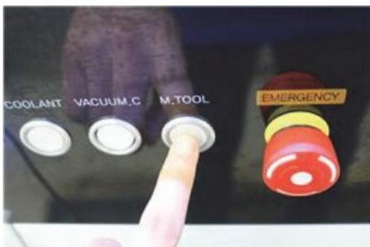
并按下机器控制面板上的‘M.TOOL’按钮。
