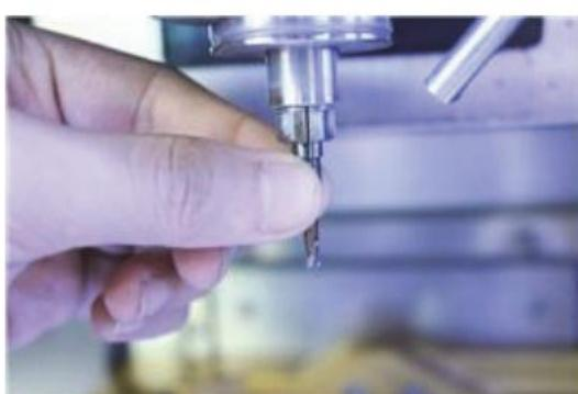
将准备好的新刀具放入到主轴内并推到底。如果刀具没有插到夹头底部，机器运转时刀具可能被损坏。
