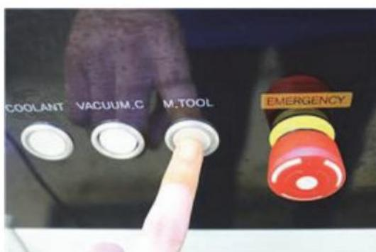
放入新的刀具后再次按下‘M.TOOL’按钮，刀具被夹紧。
