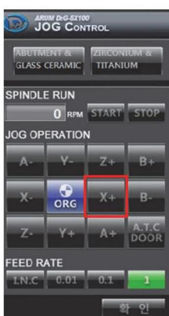
手动更换工具。用户需将机器改成手动模式。当轴被控制面板手动移动时手动模式将激活。
