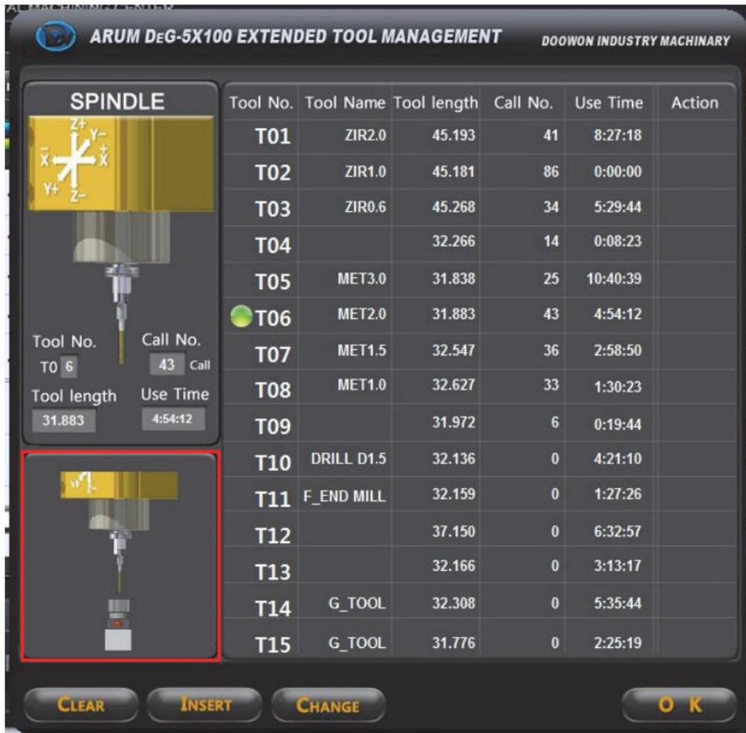
如果刀具被手动改变，长度补偿值也将会改变，因此用户在手动换刀具后应重新进行刀具长度测量。
