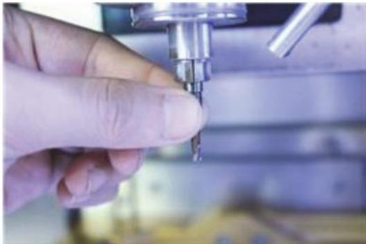
用手拿住主轴上的刀具，防止刀具跌落对工具造成损伤。
