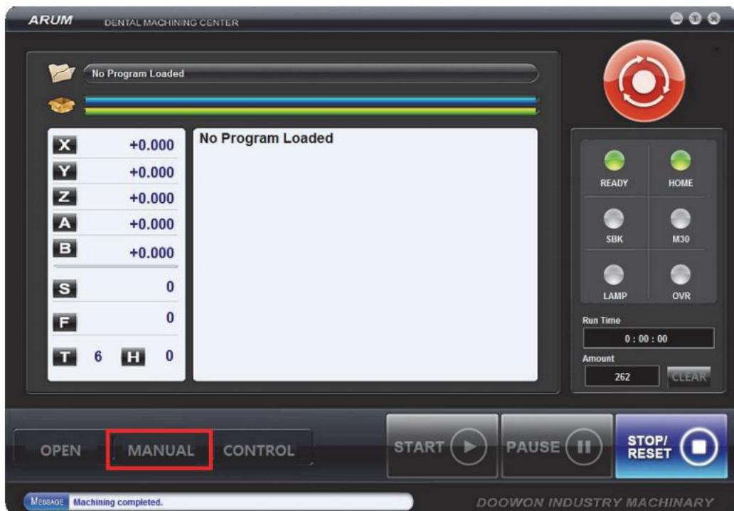
如过刀具在主轴内破损或损坏时，用户必须在主轴内直接更换刀具。用户需要通过控制面板来进行手动更换刀具，点击‘MANUAL(手动)’按钮时该菜单显示。
